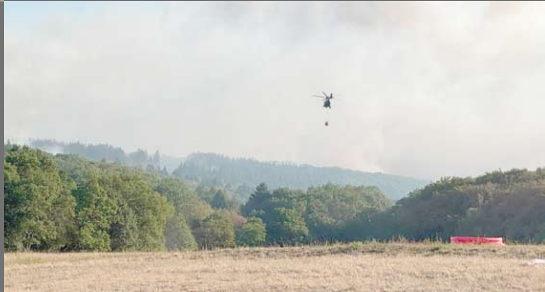
Hubschrauber können mit speziellem Transportgerät Wasser aus mobilen Löschwasserbehältern aufnehmen und Brände aus der Luft bekämpfen. Foto: FaltSilo GmbH
