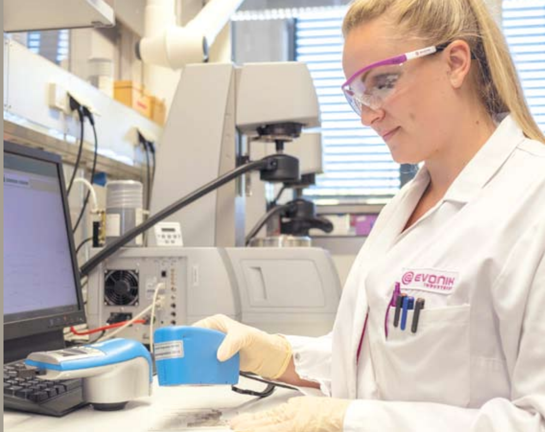
Katrin Basler (Chemielaborantin bei Evonik Oxeno) überprüft hier den Gelbwert einer Bewitterungsprobe einer PVC-Dachbahn, die 24 Monate lang im Freien gelegen hat. Foto: Evonik Oxeno
