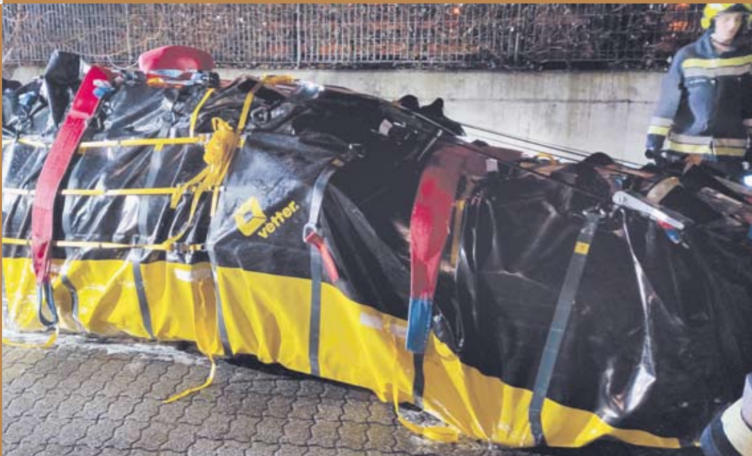
Nach dem Löschen wurde das Plug-in-Hybrid-Fahrzeug mit der PVC-beschichteten Plane umhüllt, die mit Wasser befüllt ein erneutes Entzünden des Akkus vermeiden konnte. Foto: Freiwillige Feuerwehr Leifers
