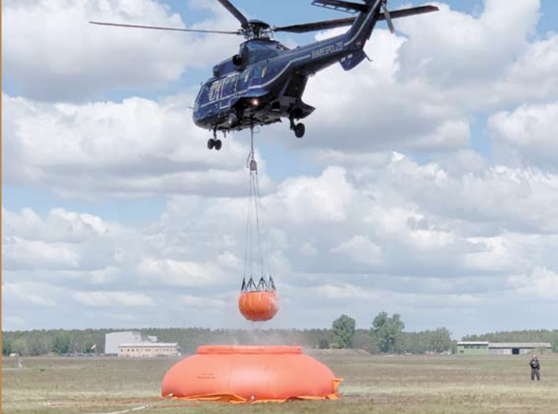
Aus mobilen Löschwasserbehältern können Hubschrauber mit speziellem Transportgerät Wasser entnehmen und Brände aus der Luft bekämpfen. Foto: FaltSilo GmbH
